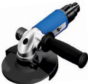
HT0912964 5" Углошлифовальная машина Свободная скорость 12000 об/мин Рабочий диаметр 125 мм (5") Мощность 1,2 кВт Потреб. воздуха 764 л/мин Подвод воздуха 3/8" Длина 223 мм Масса 1,44 кг
