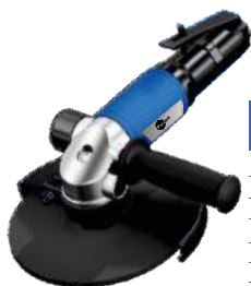
HT0912096 7" Углошлифовальная машина Свободная скорость 7600 об/мин Рабочий диаметр 180 мм (7") Мощность 1,324 кВт Потреб. воздуха 1245 л/мин Подвод воздуха 3/8" Длина 280 мм Масса 2,7 кг
