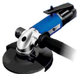
HT0912974 5" Углошлифовальная машина Свободная скорость 12000 об/мин Рабочий диаметр 125 мм (5") Мощность 1,2 кВт Потреб. воздуха 764 л/мин Подвод воздуха 3/8" Длина 223 мм Масса 1,44 кг
