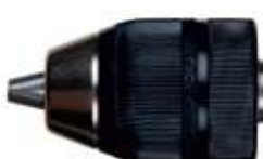
HT-G214J Кулачковый патрон JACOBS с ручной затяжкой, стальной конус Размер патрона 1/2" Резьба шпинделя 3/8"-24T
