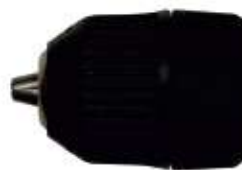
HT-G211J Кулачковый патрон JACOBS с ручной затяжкой Размер патрона 3/8" (10 мм) Резьба шпинделя 3/8"-24T
